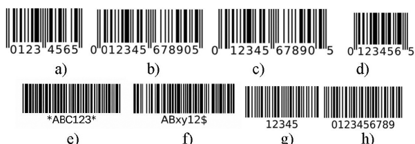
Рисунок 1. Виды одномерных (1D) штрих-кодов: а) EAN-8; б) EAN-13; в) UPC-A; г) UPC-E; д) Code 39; е) Code 128; ж) Codabar; з) ITF
