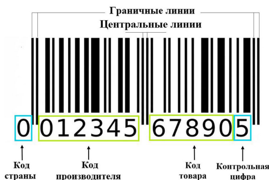
Рисунок 2. Структурное строение штрих-кода EAN-13
