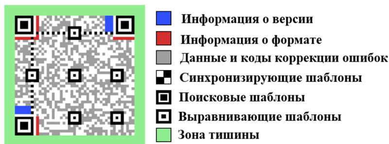
Рисунок 5. Структурное строение QR-кода
